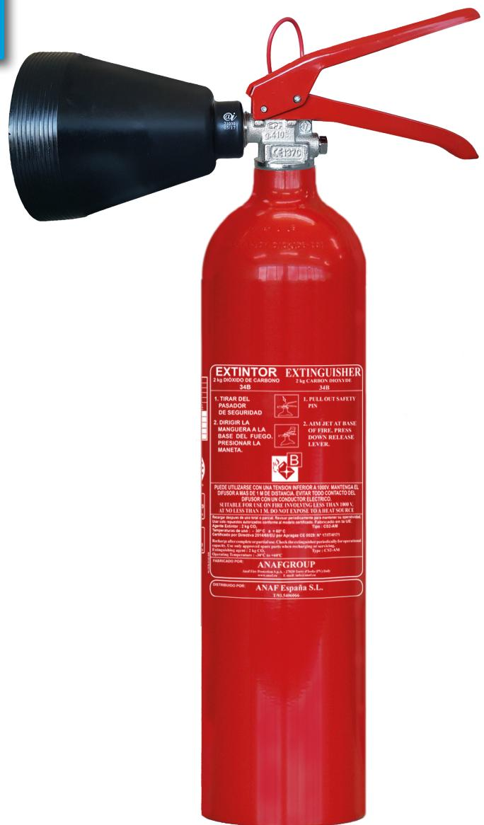
**CS2-AM es un extintor de gas CO<sub>2</sub> con valvula y vaso difusor. Alcance de la temperatura de funcionamiento -30 + 60 °C. Valido también para su uso en países con bajas temperaturas. Certificado en conformidad con la Directiva PED 2014/68/EU de los Equipos a Presión y con la Directiva MED 2014/90/EU de los Equipos de Marina. Capacidad 2 kg.**
