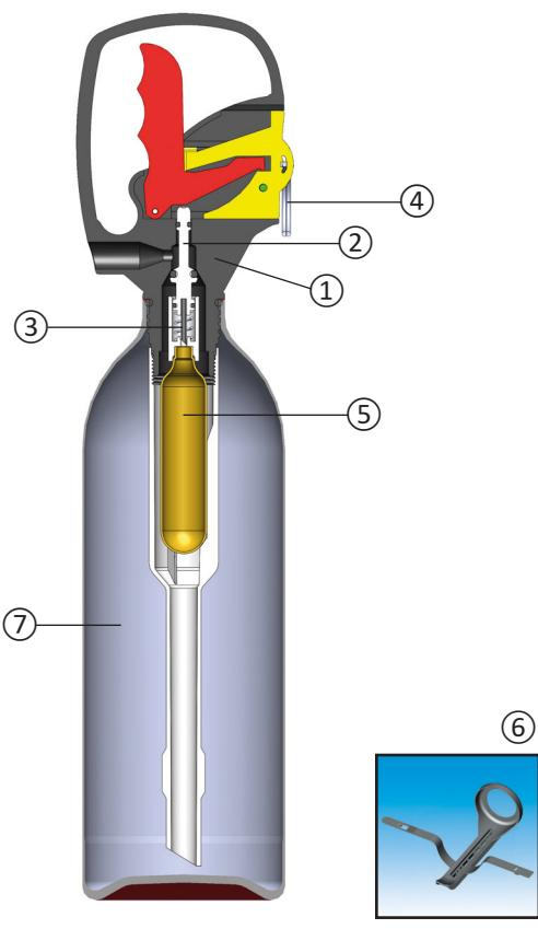
① La vanne est constituée de résine acétal assurant la protection contre la corrosion.
